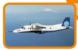
ジネダムが開発したフライ・バイ・ ワイヤ操縦装置やデータ収集 装置など飛行試験に必要な 機器を組み込んだ 機体です。
