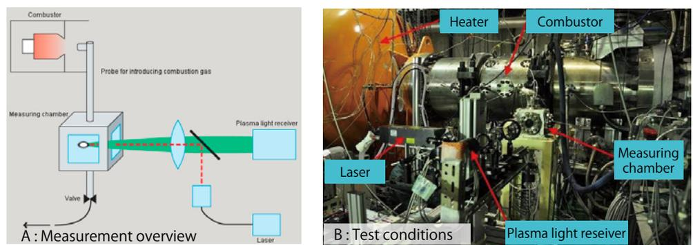
Fig. 4: LIPS test using actual combustion gas
