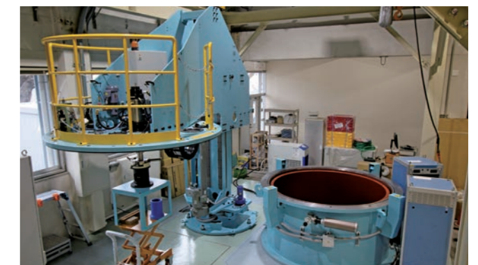
軽量低圧タービン翼の回転試験 Blade Vibration Test of Lightweight LPT Blade
