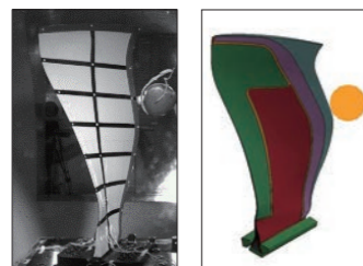
高速衝撃試験・解析 High-Speed Impact Test and Analysis
