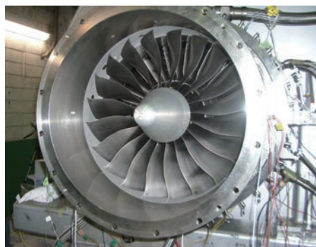
層流ファン (aFJRファン) 技術実証供試体 先進の3D-Aero デザイン採用超音速ファン
