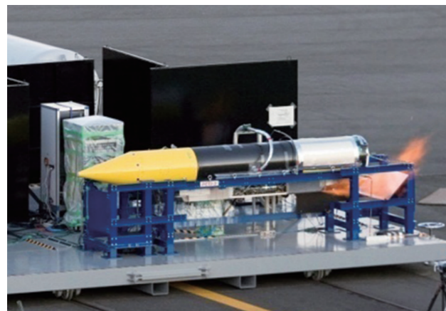
地上静止燃焼実験 Sea Level Static Firing Experiment
