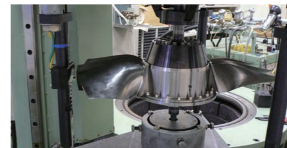
軽量ディスクの耐久性試験 Durability Test of Lightweight Disk
