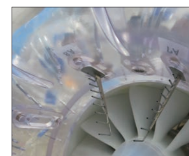
ファン及びインテークの模型 Subscale Model of Fan and Intake
