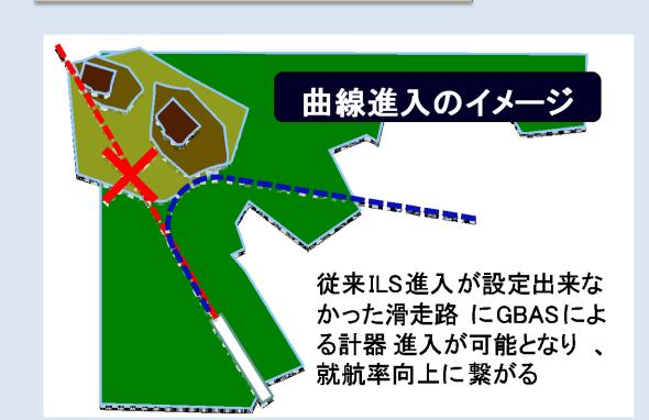
飛行軌道制御技術では、地形等の制約で計器進入ができない空港でGLS (GNSS Landing System, GPSによる着陸システム)を用いた曲線進入が出来るようにすることにより、これらの空港で就航率の向上を目指します。
