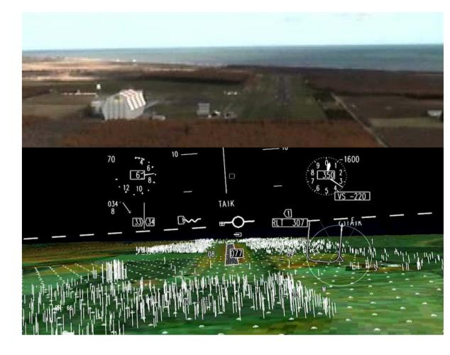
障害物をレーザ距離計などで. 検出 して表示する技術を開発中です。
