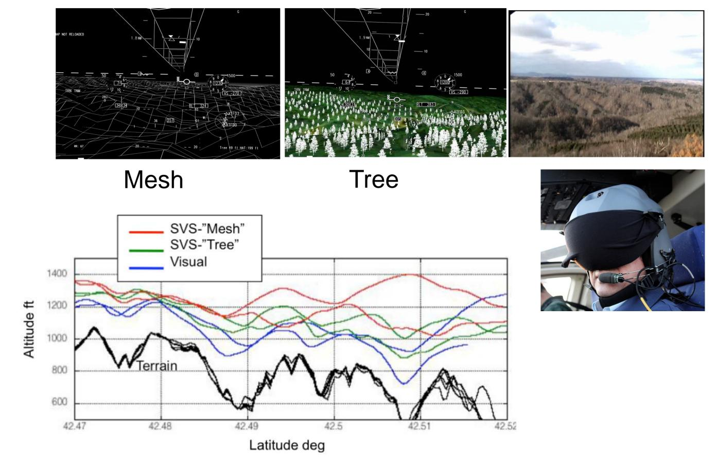
低空で起伏のある地形を追従する実験を行いました。窓外視界を使った 場合と、二種類の表方式を比較し、高度感を高めるために開発し た"TREE"型表示が有効であることが示されました。
