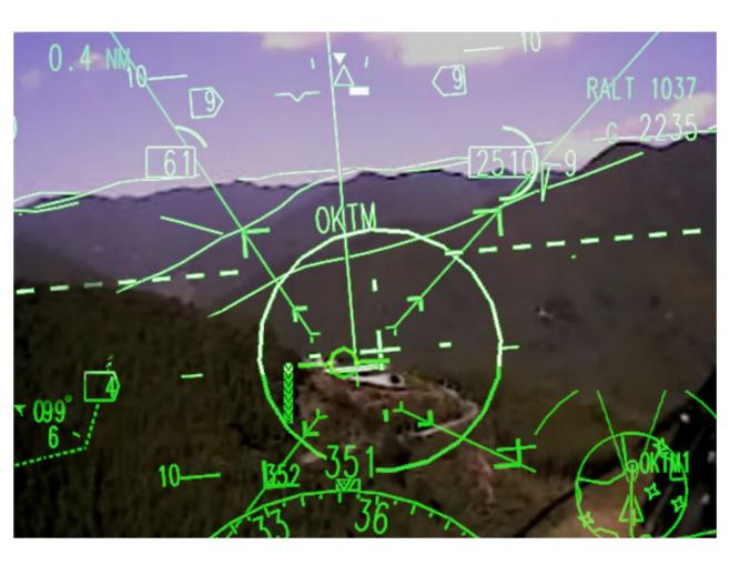
目標経路を三次元的に表示し、手 動操縦での精密な経路追従を可能 にします.
