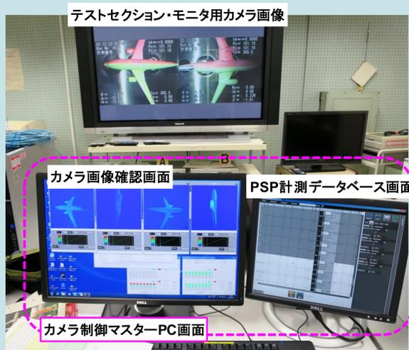
基幹PSP計測システムでのカメラ制御システム
