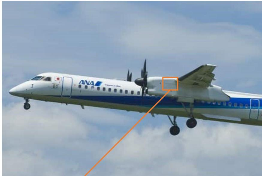
Engine Driven Pumpの装着位置
