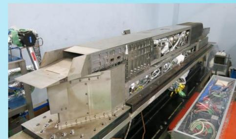
マッハ5クラスの極超音速旅客機の実用化を目指して、離陸からマッハ5まで連続作動できる「極超音速ターボジェット」の研究開発を進めています。これまでに、マッハ4飛行環境でのエンジン運転実験を実施し、推進性能を取得しました。また、大学と連携して極超音速飛行実験(マッハ5)に向けた準備を進めています。
