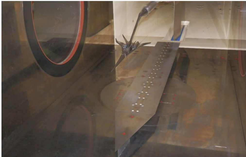
NASA/Boeing N+2ブーム評価モデルを用いた JAXA超音速風洞試験
