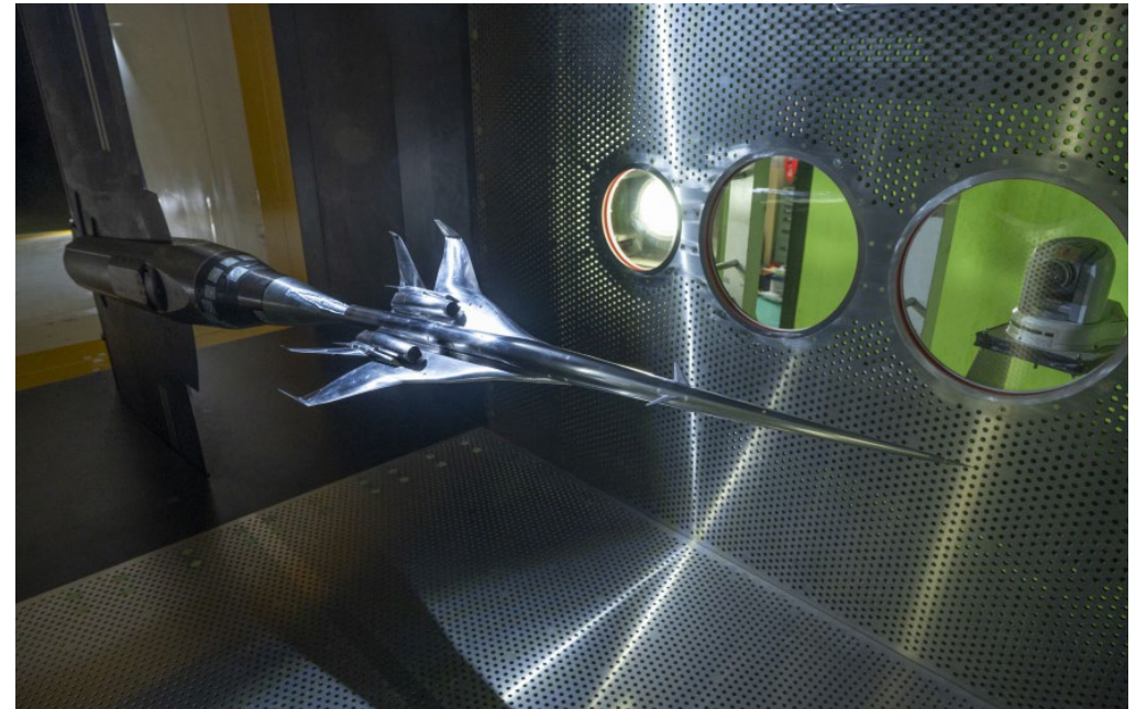
NASA/Boeing N+2性能評価モデルを用いた JAXA遷音速風洞試験
