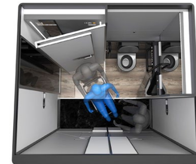
機内バリアフリートイレ 「メタモルフィック・ラボラトリー」
