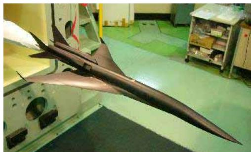
小型 SST (1 次形状) 超音速風洞試験
