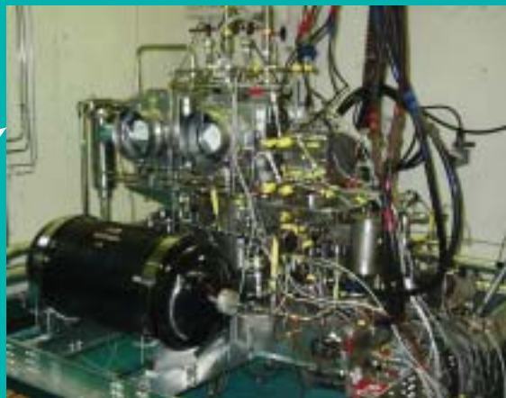
搭載型1kW再生型燃料電池システム
