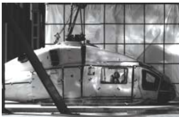
図2 着地0.12秒後の試験と解析の比較図
