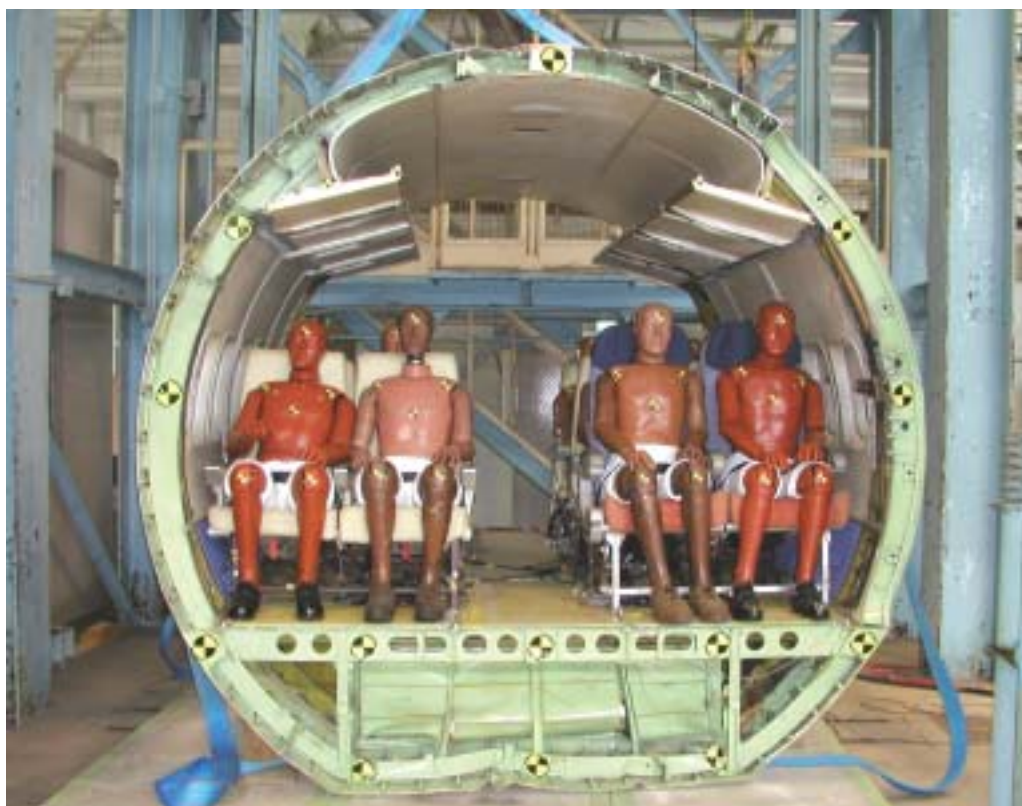
図1 YS-11輪切り胴体の落下試験後の様子
