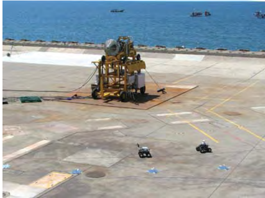
図2 実験用エンジンの騒音試験
