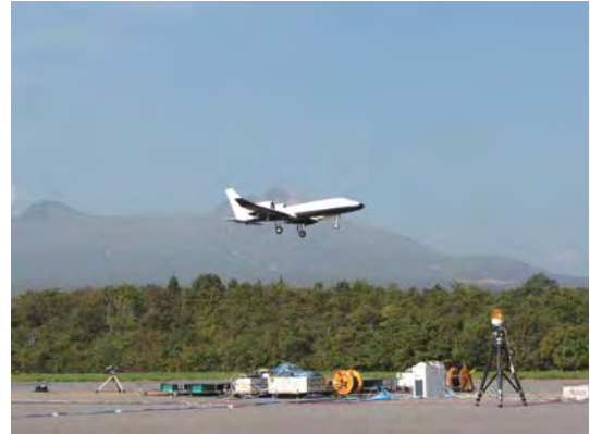
図3 模型機による騒音試験
