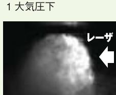
大気圧下と実際のエンジンに近い高圧気流下の噴霧の違いは「雨」と「霧」の違いに似ている。2で右側だけが明るいのは、燃料の濃霧が光を遮るために。
