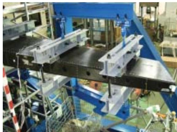
図5 A-VaRTM実大垂直尾翼静强度試験(水平支持)
