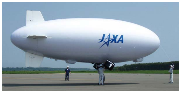
図2 飛行船型無人機
