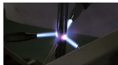
加熱・冷却サイクル試験の様子
