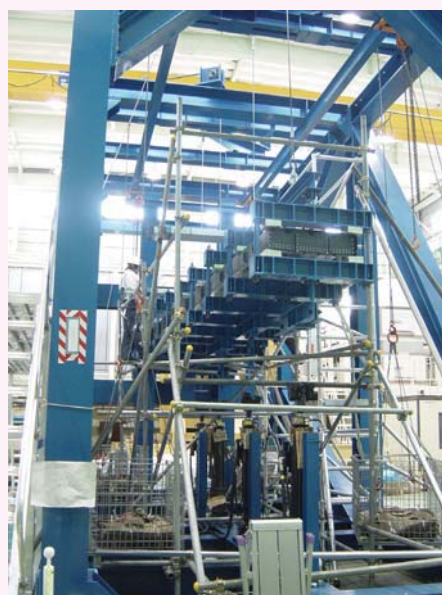
低コスト複合材実大主翼試験の様子
