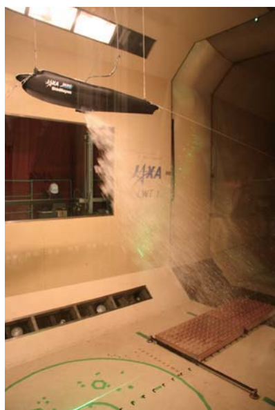
図2 風洞における放水試験
