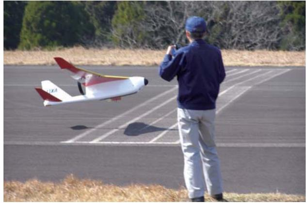
図3 低速高降下角進入評価試験
