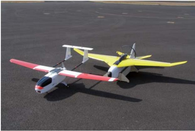
図2 自動飛行技術評価試作機(左)、短距離発進回収技術評価試作機(右)
