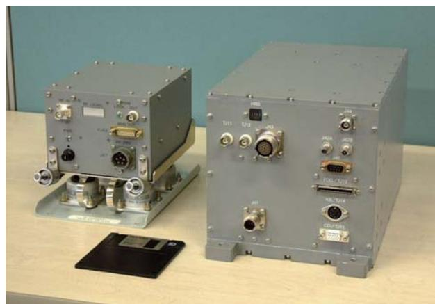
図1 GPS補強型慣性航法装置“GAIA”
