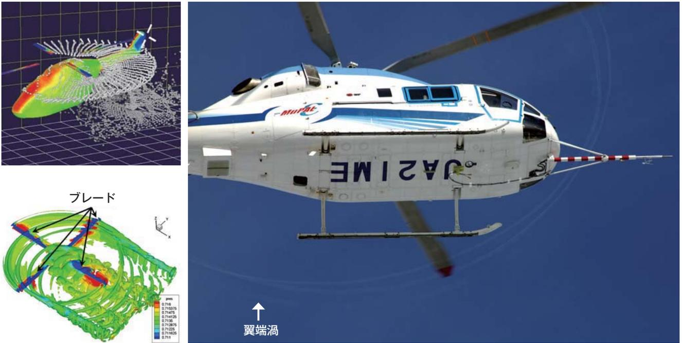
図2 ブレードから出る空気の渦のようす
