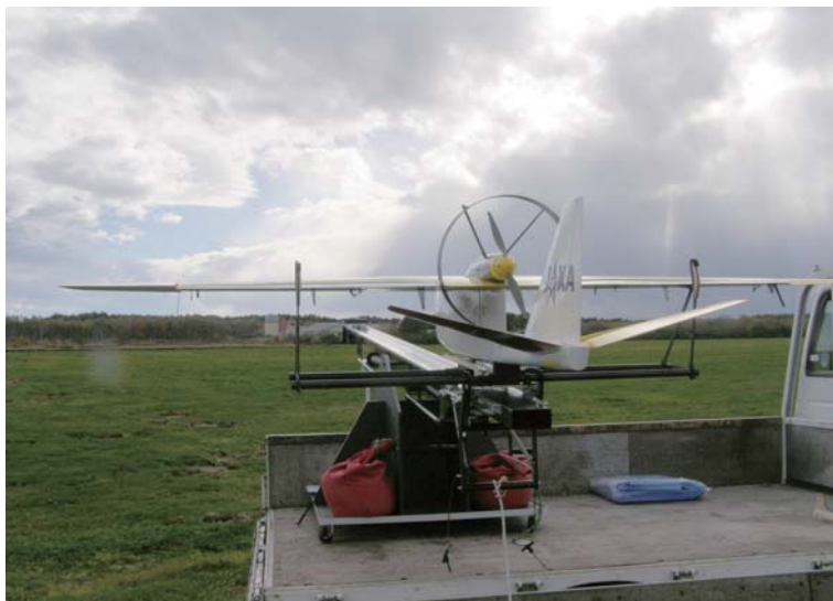
図1 カタパルト発進装置に設置
