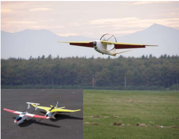
試験機 機体赤：自動飛行技術確認用、黄：短距離発進回収技術確認用
