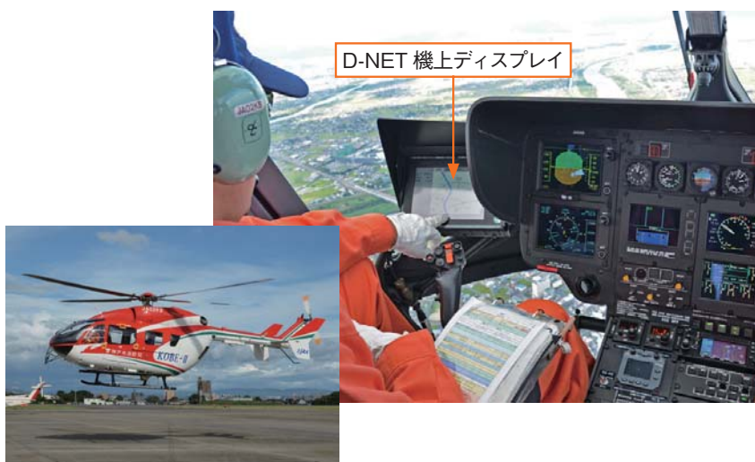
図4 ● D-NET機上システムの搭載状況
