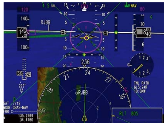
図7 GLSにより地上から送信された経路を表示した実験用の計器
