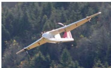
無人機が高度約200mから撮影した画像(右)。機体は全長1.6m、重量5kgで20分間飛行できる
