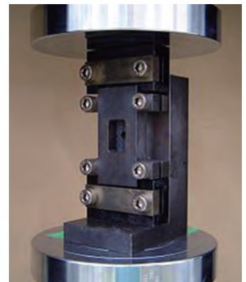
ISO規格となった有孔圧試験法治具(ISO12827)
