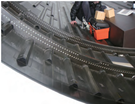
CFRPを多用した航空機胴体構造の例(デモンストレーション品)
