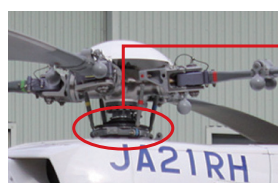
メインローターの根元にあるスワッシュプレートで回転面を傾ける。
