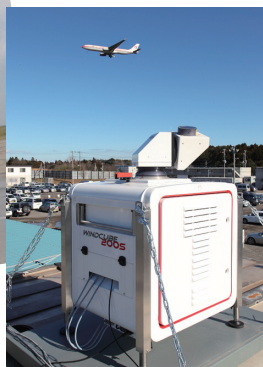
成田空港周辺で実施した風計測ライダーによる後方乱気流の計測試験
