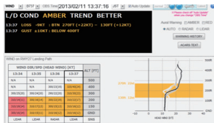
LOTASの画面例。高度・時刻別で、重要度に応じて表示色を変更するなど、視認性にも配慮している。
