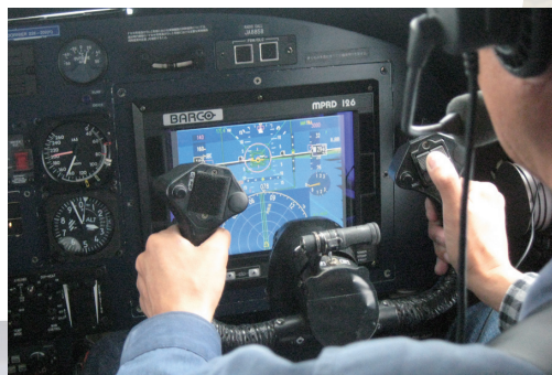
実験用航空機MuPAL-aで飛行実験した飛行軌道制御技術
