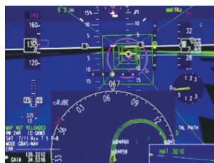
コックピット内に表示されるトンネルインザスカイの画面例。GBASで設定される進入経路が画面に表示される。
