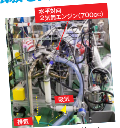
レシプロエンジンを使った高空過給エンジンの試験装置
