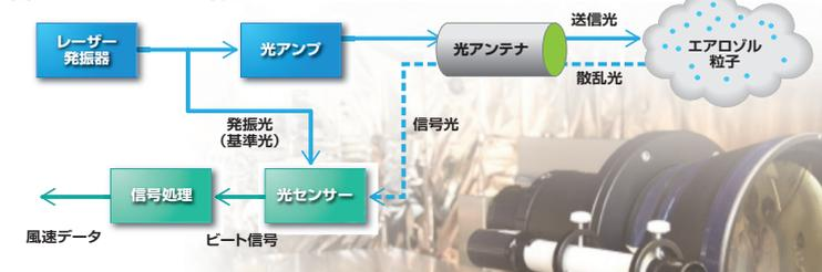
赤外線を使用したことと、光アンプ(増幅器)を使ったヘテロダイン方式を採用したことが挙げられます。1.5μmの近
