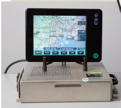
ヘリコプター機上に搭載でき、地上局と情報交換を行う地図情報表示装置「NMS-01S」
