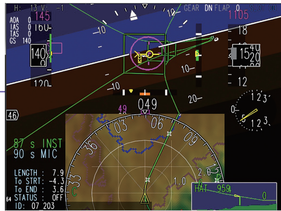
コックピット内に表示されるトンネル・イン・ザ・スカイの画面例
