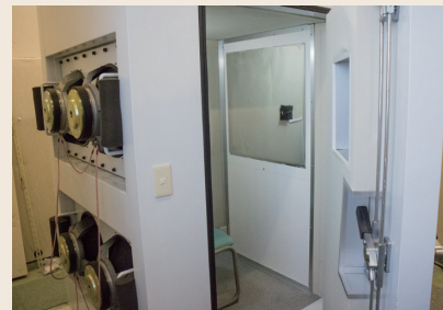
ドアを開けた状態。左手に見えるスピーカーが、背面側の低周波用スピーカー。
