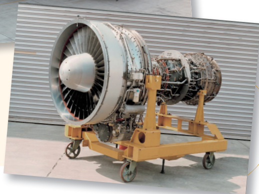
実験用ターボファンエンジンとして開発されたFJR710
