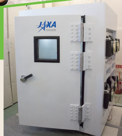
ソニックブームシミュレータの外観。壁の厚みは10cmあり、防音対策も取られている。
