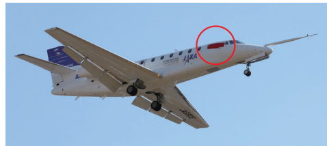
リブレットの加工を施された「飛翔」(赤線の丸囲み部分)
