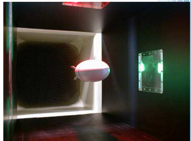
写真2 磁力支持装置によって浮上した飛行船模型
