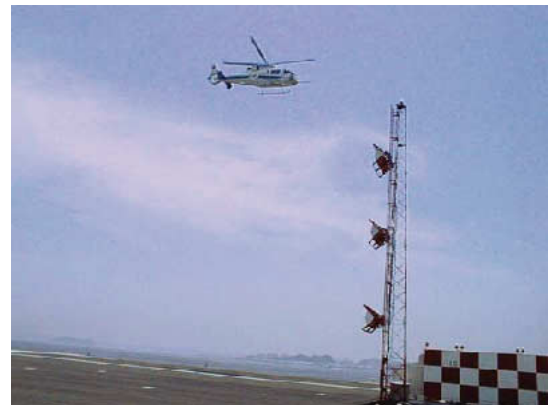
写真2 ILS進入後、GS局アンテナを通過するMuPAL-
