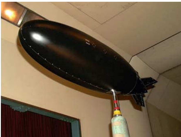
写真1 大型低速風洞において支柱に支持された飛行船模型
