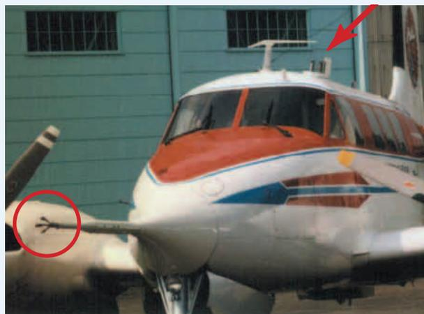
写真 航空機に装着された超音波風速計(円内)と大気採取プローブ(矢印)
