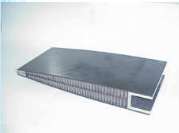
写真 耐熱熱可塑複合材(IM600/PIXA-M)を用いた前縁構造模型
