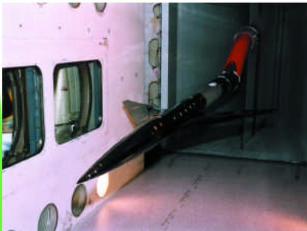
写真1 23.3%ロケット実験機模型(全長1870mm)
