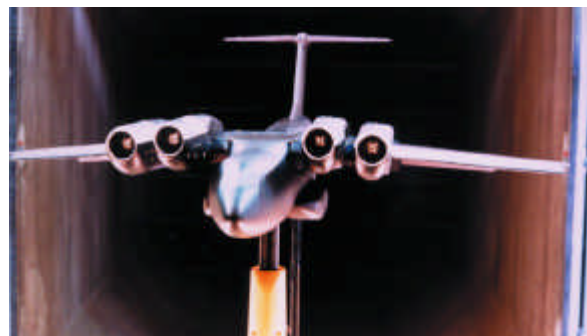
短距離離着陸機「飛鳥」模型の風洞試験
