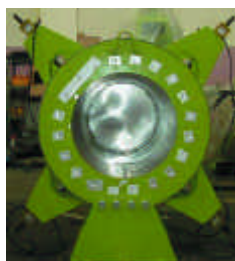
円筒吸音ダクト
