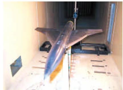
写真2 2m×2m低速風洞（旧突風風洞）にセットされた模型
