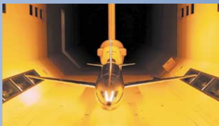
写真 6.5m×5.5m低速風洞用ONERA M標準模型 (P3)
