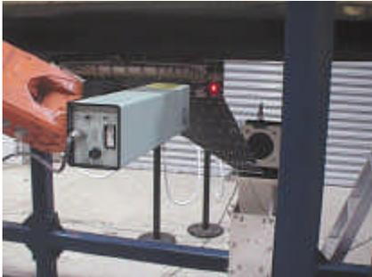
写真1 動的変位計測装置(DDMS)を用いて振動試験中の半載エルロン模型
