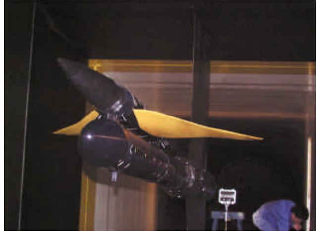
写真4 打上形態全機模型（遷音速風洞取付状態）
