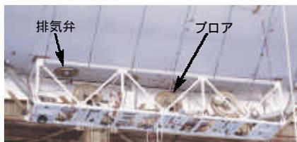
供試体に取り付けられたフロアと排気弁
