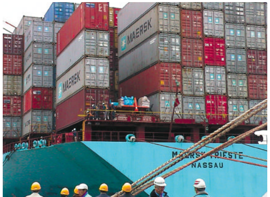
写真2 船尾に積載された組立台車（コンテナの谷間に位置）
