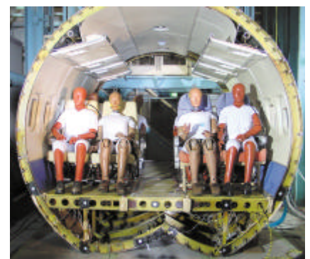
写真2 落下衝撃試験後の状況
