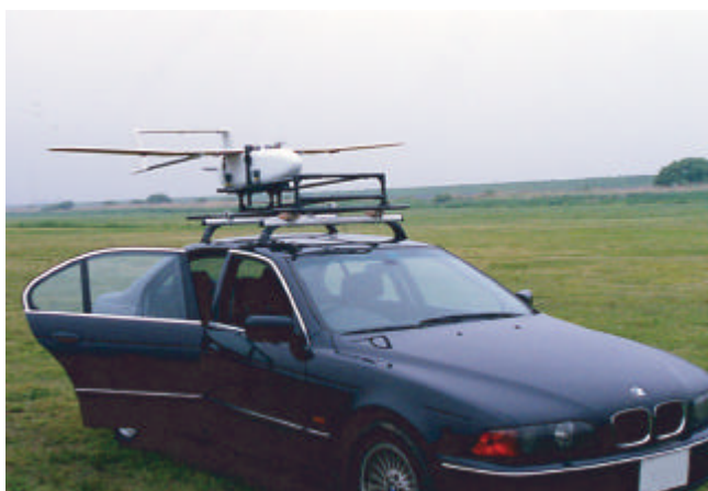
写真1 発進台に装着した状態
