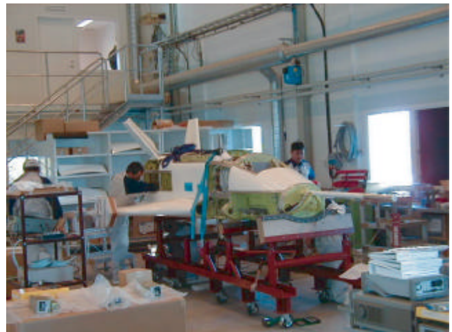
図3 実験機の開梱および点検作業の様子
