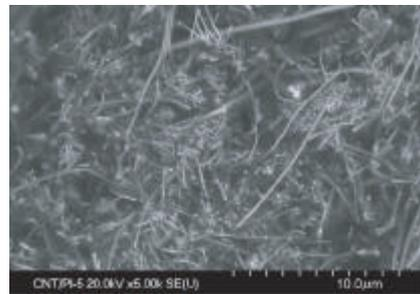
耐熱ポリイミド複合材料の電子顕微鏡写真
