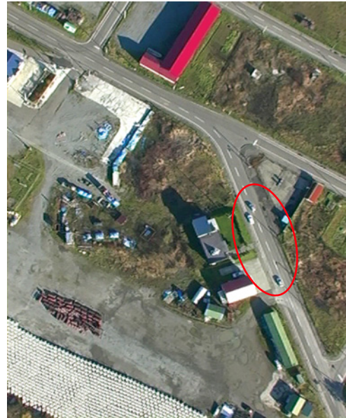
図2 高分解能センサによる交通観測の基礎実験 30cmの空間分解能で動画を撮像し、車両確認の基礎実験として走行車両の時系列データを取得しました（高度：約500m）。
