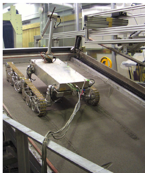
図3 クローラ型探査車の斜面登坂実験
