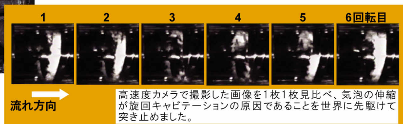
図3 旋回キャビテーション発生の様子
