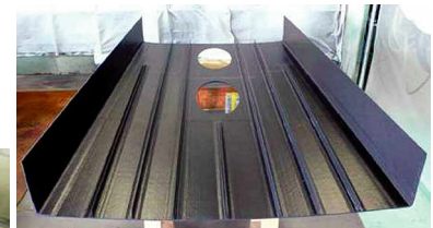
B: 供試体(長さ:2m) (左)樹脂を流す前の状態 埋め込んだ光ファイバーが見えています。 (右)樹脂を流し込んで固めた状態 メンテナンスホールと呼ばれる整備用の窓を加工し、実際の航空機構造に近いものとしています。
