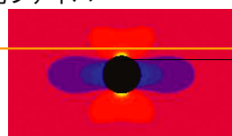
円孔周りのひずみの解析結果
