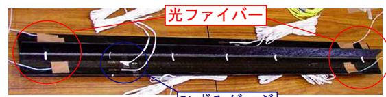
A: 供試体(長さ:1m) 埋め込んだ光ファイバーと表面に貼り付けたひずみゲージが見えています。
