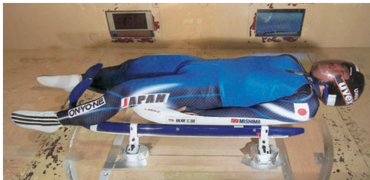
2m×2m低速風洞(約150km/時)でのトリノ五輪代表牛島選手による試験の様子 (日本ナショナルリュージュチーム提供)
