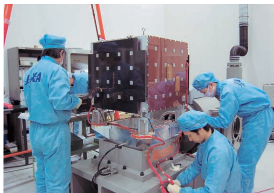
図2 SDS-1の振動試験
