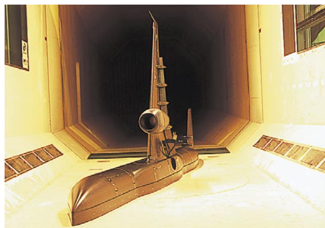
JAXA 6.5m x 5.5m 低速風洞に設置された三菱リージョナルジェット（MRJ）半裁模型（写真：三菱重工業株式会社提供）
