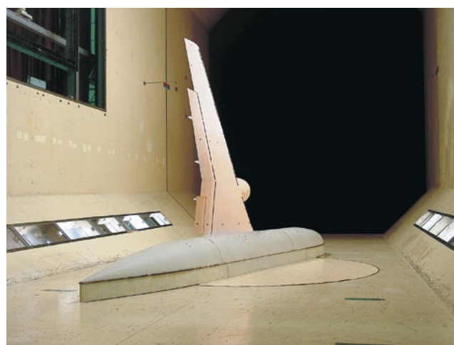
模型サイズ：胴体長さ4.9m、床面から翼端まで2.3m
