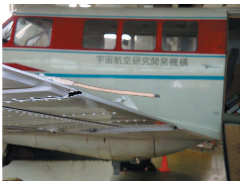
空気の摩擦などにより機体に溜まってしまふ静電気を逃がすため、翼後縁や降着装置には放電装置が付いています。写真は主翼後縁に取り付けられた放電索と呼ばれる放電装置です。
