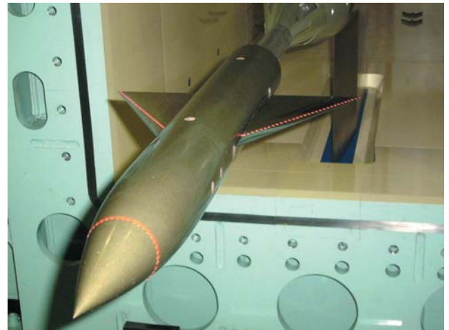
図4 JAXA超音速風洞に設置したAGARD-B標準模型
