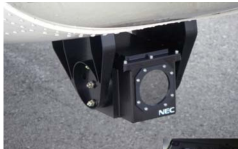
図4 機体下部に搭載されたFLIR
