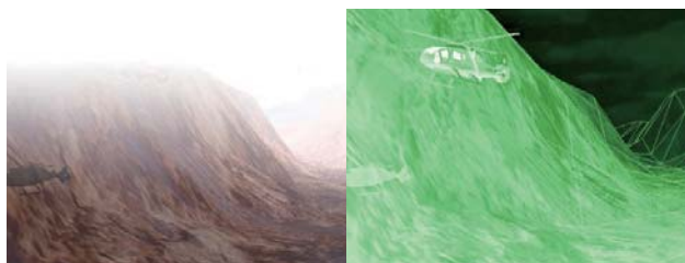
FLIRやレーダー、地形のデータベースなどを組み合わせることで、目視では確認が困難な障害物や地形などを映し出します（右）。
