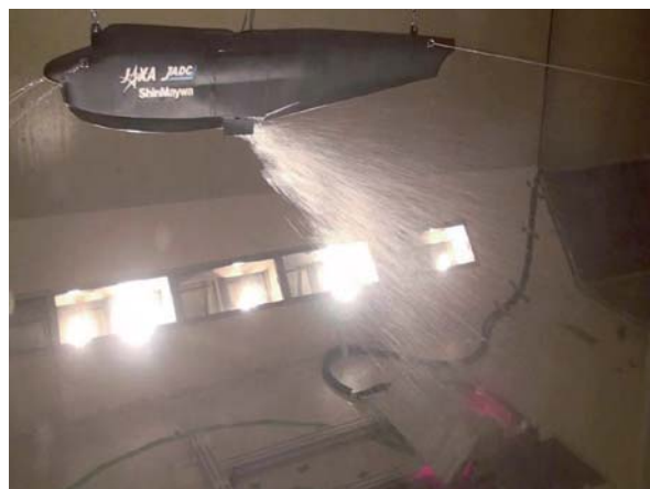
図2 消防飛行艇の放水試験
