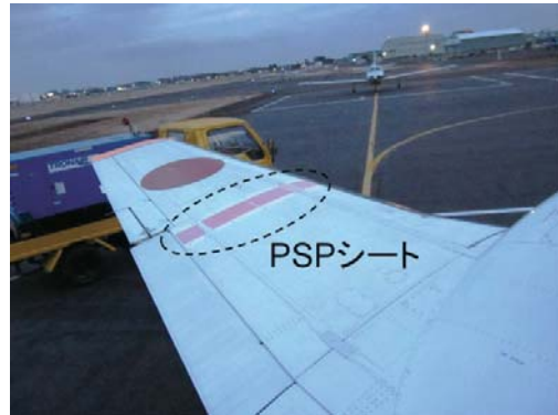
図1 左主翼に貼り付けたPSPシート
