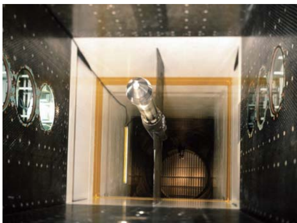
図1 H-2ロケットフェアリングの性能評価試験
